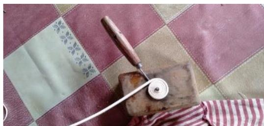
Gambar 9. Proses Perapatan Batang Rotan
